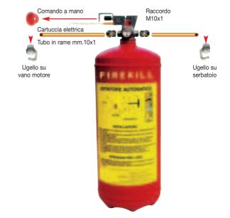
La valvola FIREKILL dispone di due uscite Ø 3/8" alle quali si collegano tubazioni di rame con un massimo complessivo di 4 ugelli che così erogano il getto estinguente con precisione nel punto effettivo del rischio di incendio.
